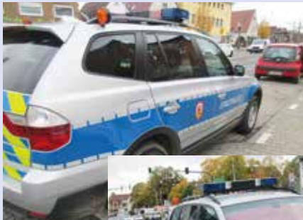
anlage, Polizeibeklebung und Warnmarkierung sowie extra Blinkleuchten am Heck ausgerüst.
